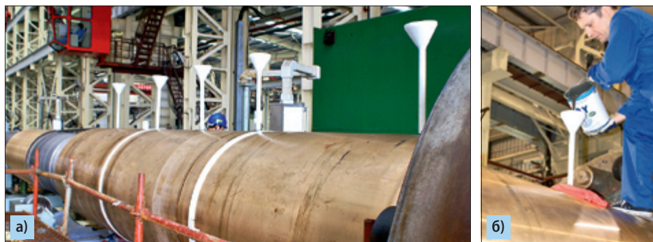
Рис. 6.17. Состав, подготовленный к заливке пластмассой (а), и способ заливки (б)
