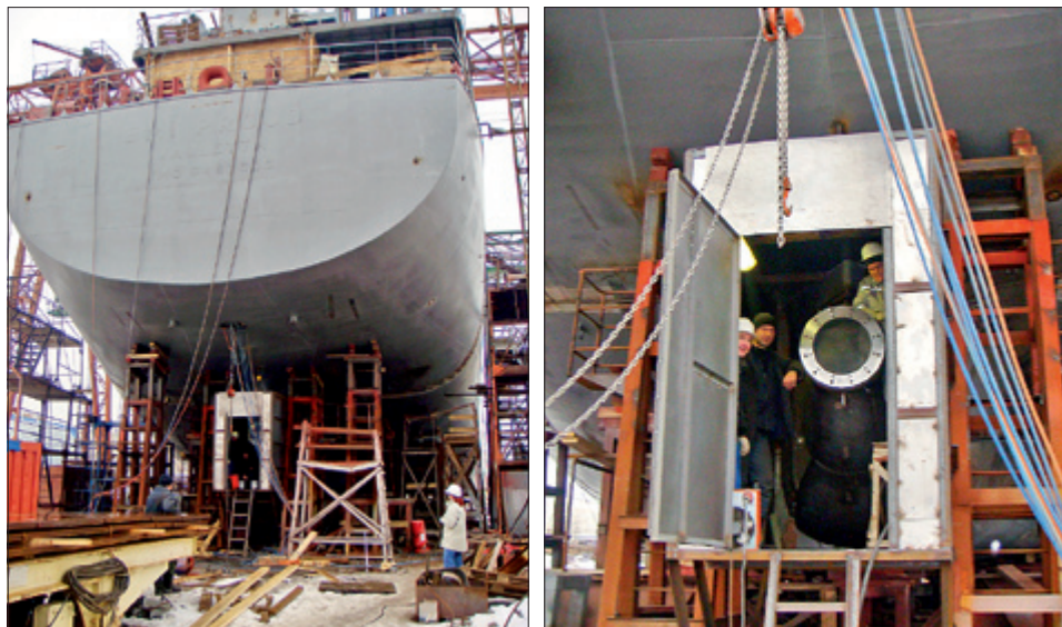
Рис. 5.19. Монтаж дейдвудной трубы в зимних условиях с применением камеры, обогреваемой нагретым воздухом (Onega Shipyard, Петрозаводск, Карелия)
