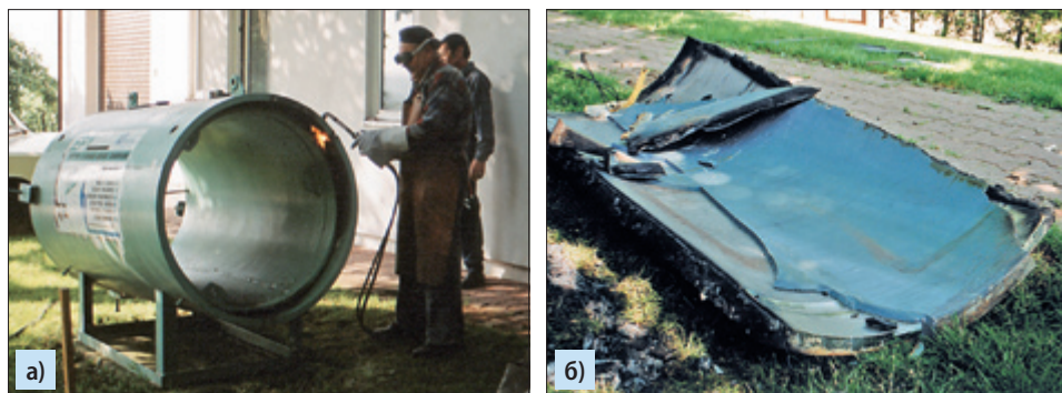
Рис. 8.33. Модель состава дейдвудной трубы с её корпусной опорой (трубой) вместе со слоем пластмассы ЕРУ во время её демонтажа: а) разрезание наружной трубы; б) верхний фрагмент наружной трубы с видимым слоем пластмассы ЕРУ
