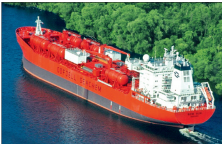
Рис. 6.23. Судно для транспортировки жидких химикалий типа В588, построенное Щецинской верфью, с палубными цистернами, установленными на подкладках из пластмассы ЕРУ
