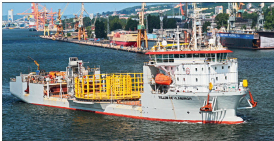
Рис. 6.36. Судно для укладки кабеля на морском дне „Willem de Vlamingh”
