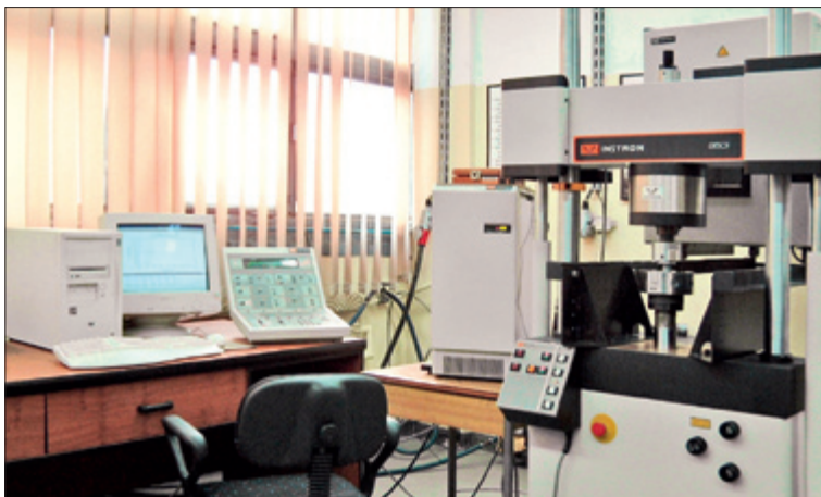
Рис. 7.12. Испытательный стенд, предназначенный для определения механических характеристик материалов во время опытов сжатия с разной скоростью деформации
