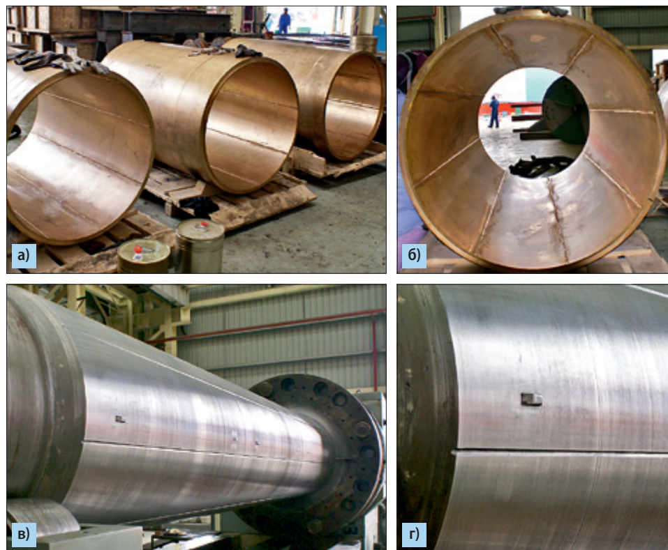
Рис. 6.15. Части втулки подшипника и гребного вала с нарезанными канавками и приваренными дистанционными элементами
