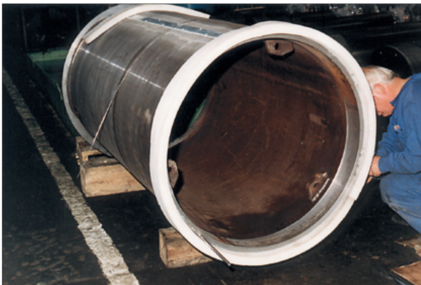
Рис. 8.27. Модель дейдвудной трубы (подшипник – внутренняя втулка)
