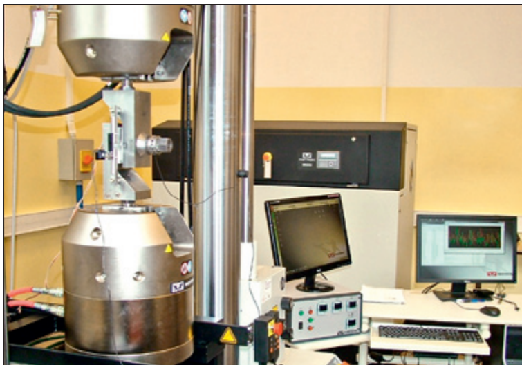
Рис. 8.72. Реализация испытаний винтового соединения со стальной подкладкой на машине Instron 8850
