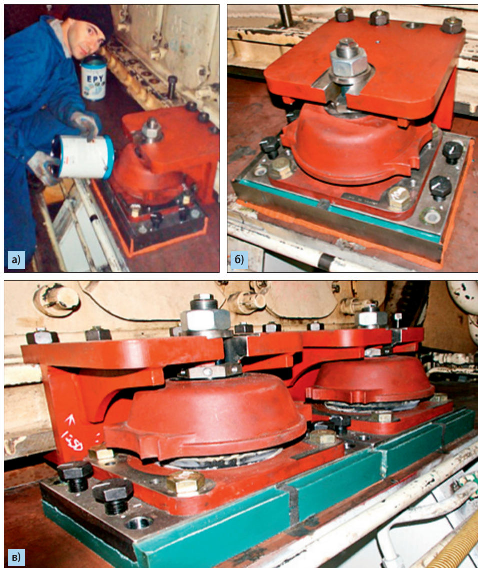
Рис. 6.7. Фундаментные подкладки из пластмассы ЕРУ под амортизаторами, установленными под главным двигателем морского судна: а) заливка формы; б) форма после заливки пластмассой; в) готовые подкладки после удаления формы
