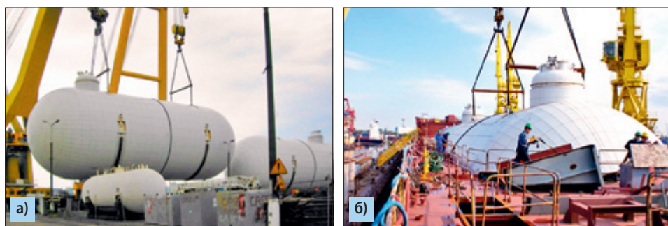
Рис. 6.26. Цистерны для транспорта сжиженных газов LNG и LPG, устанавливаемые на судне
