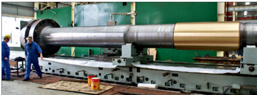
Рис. 6.11. Часть гребного вала судна, подготовленная для осадки на нём новой втулки подшипника
