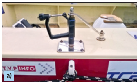
Рис. 6.40. Уключина одноместной трансокеанской гребной лодки „Pianist’a”: а) общий вид; б) способ применения пластмассы ЕРУ для её крепления к лодке
