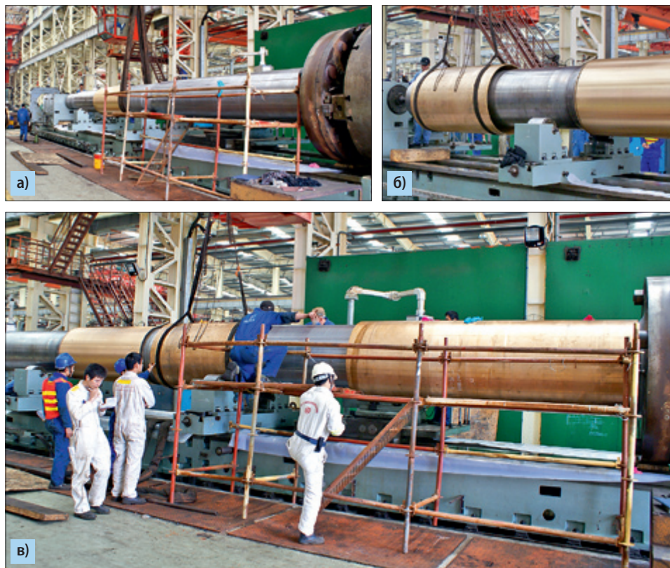
Рис. 6.16. Ход посадки отдельных отрезков втулки на подшипник вала
