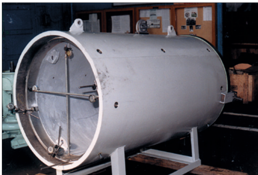
Рис. 8.30. Модель комплекта дейдвудной трубы и трубы корпусной опоры с установленными датчиками, предназначенными для измерения относительных перемещений соединяемых элементов
