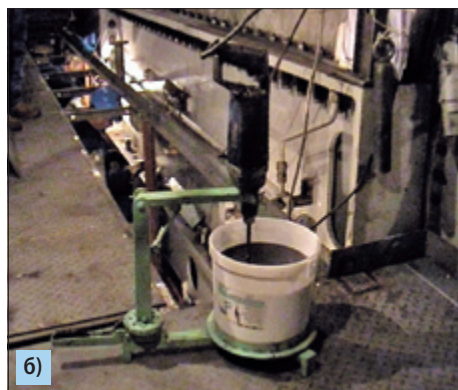
Рис. 5.2. Смешивание композиции: а) вручную с помощью ручной дрели; б) механически
