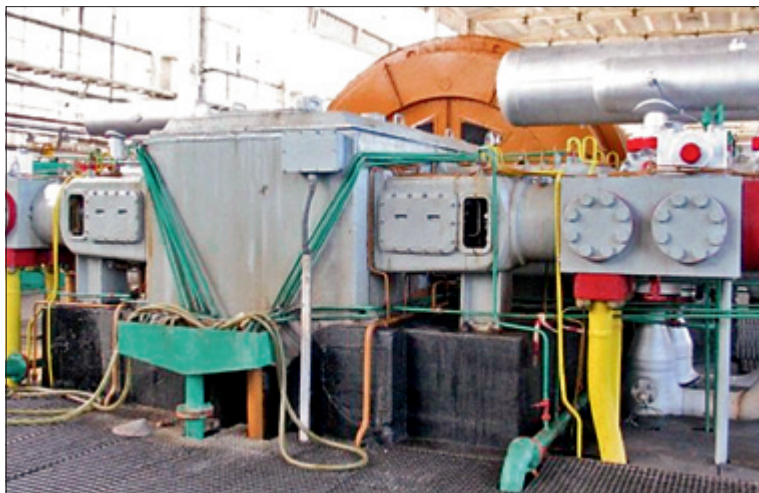
Рис. 6.41. Общий вид поршневого компрессора синтезного газа (типа 6HGP/4), установленного традиционным способом на бетонном фундаменте
