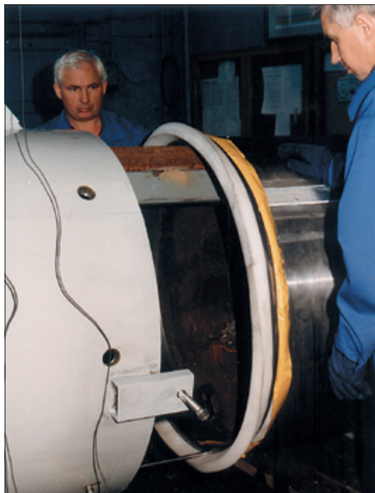
Рис. 8.29. Носовое уплотнение, изготовленное из полиуретанной пены и стального манжета (перед монтажом)
