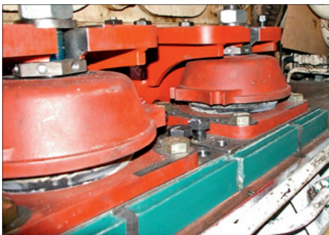
Рис. 6.5. Фрагмент эластичного крепления судового двигателя на амортизаторах, установленных на фундаментных подкладках, отлитых из пластмассы EPY
