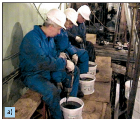
Рис. 5.2. Смешивание композиции: а) вручную с помощью ручной дрели; б) механически
