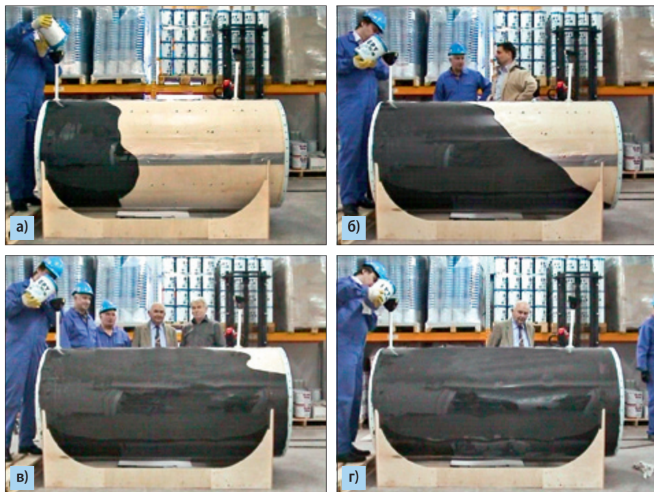
Рис. 6.14. Модельное исследование хода и времени заполнения жидкой пластмассой EPY заливной щели между валом и втулкой
