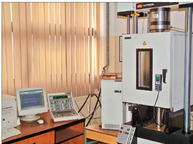
Рис. 7.25. Стенд для определения характеристик деформации пластмассы при постоянно действующей нагрузке и при возрастающей температуре
